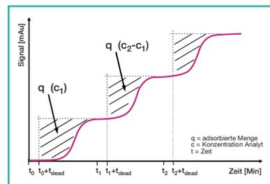
**Auswertung:** aus der Zeitspanne von der Konzentrationserhöhung bis zum **Durchbruch** (unter Berücksichtigung des Totvolumens) ergibt sich durch Multiplikation mit der Konzentration direkt die Menge an aufgenommenem Adsorbat. Somit erhält man direkt die **Adsorptionsisotherme** unter den jeweiligen sehr gut definierten chromatographischen Bedingungen.
